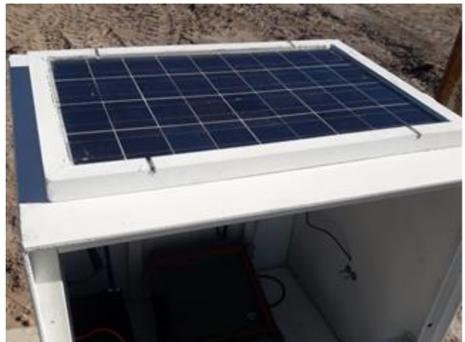
Ubicación de la pantalla solar en la parte superior del gabinete
