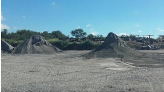
En la imagen se observa un escaso acopio de arena de trituración de origen basáltico. Luego empezó a ingresar otro material de cantera Cantesur, con una graduación granulométrica mucho más fina principalmente en los tamices N°8, 30 y 50, con dispersiones en más de 4%, 14,1% y 11,4%
