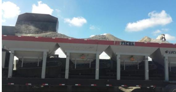
En la imagen se visualiza las tolvas de la planta asfáltica y el fenómeno de contaminación mencionado anteriormente.
