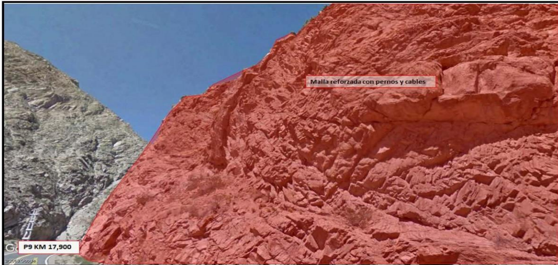
Figura 25: Esquema de protección de laderas propuesto para el contratualud P9.
